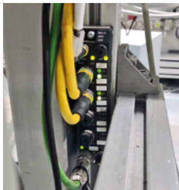
Turcks kompaktes TBEN-S2-RFID-Interface sorgt für schnelle und sichere Datenübertragung
