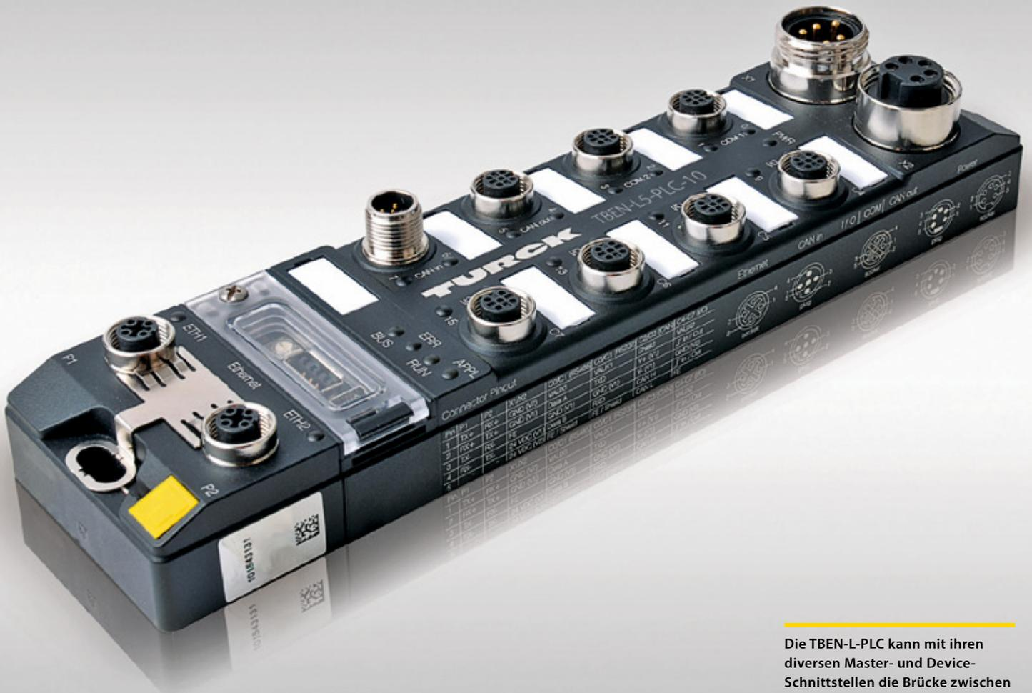
Die TBEN-L-PLC kann mit ihren diversen Master- und Device-Schnittstellen die Brücke zwischen Ethernet und CANopen bilden
