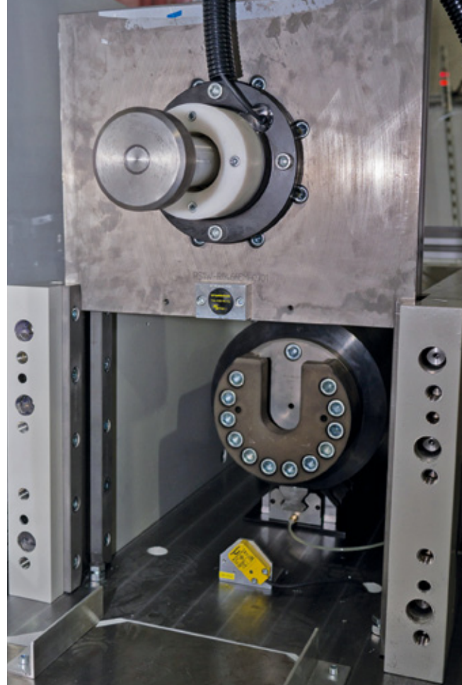
Der Datenträger TW-R30 oben am Werkzeug lässt sich auch zuverlässig lesen, wenn er auf Metall montiert ist
