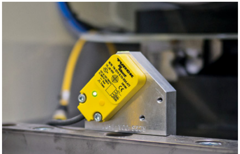
Der RFID-Schreiblesekopf TN-Q14 in IP67 überzeugt mit seiner kompakten Bauform
