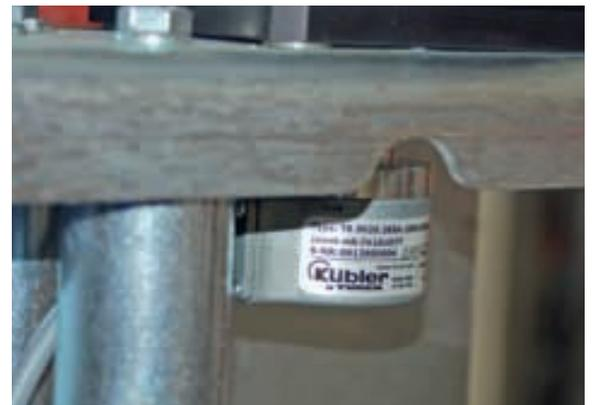
**Für einen Pro-Pack-Kunden hat Turck einen speziellen Drehgeber mit d-sub-Steckverbinder gebaut**
